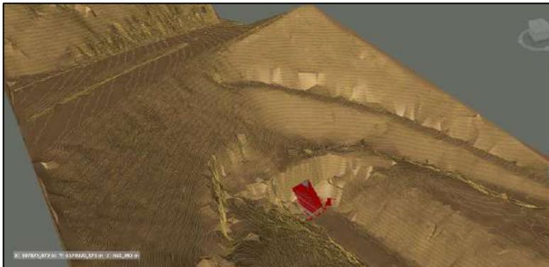
**Ilustración 194: Modelo del emboquille de entrada (Fuente: Elaboración propia)**
