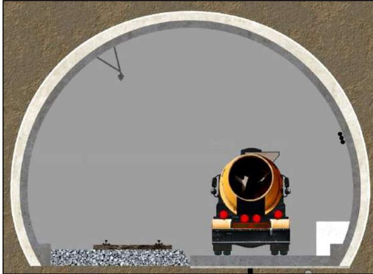
**Ilustración 270: Revestimiento, catenaria definitiva en vía 1, desplazamiento de vía 1 provisional, y hormigonado de losa y andén en vía 2 (Fuente: Adif, 2017)**
