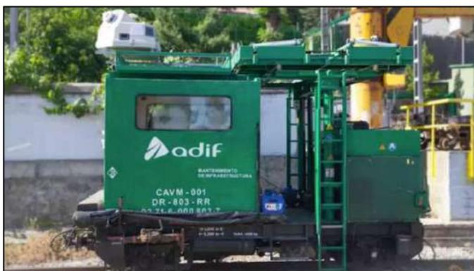
**Ilustración 77: Láser escáner montado sobre dresina de Adif (Fuente: Adif, 2018)**
