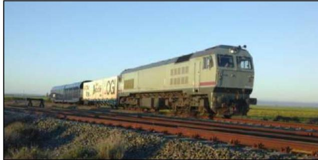
**Ilustración 162: Pruebas del eje de ancho variable en mercancías (Fuente: Adif, 2020)**
