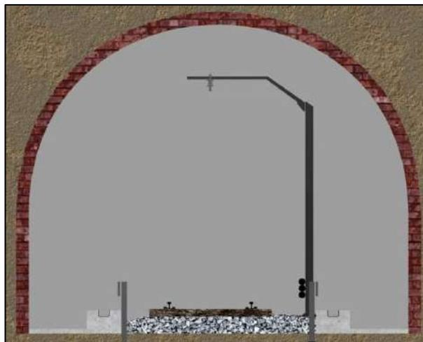
**Ilustración 267: Instalación de catenaria rígida central, paso de doble vía a vía única provisional central y cimentaciones guías de rodadura maquinaria TES (Fuente: Adif, 2017)**
