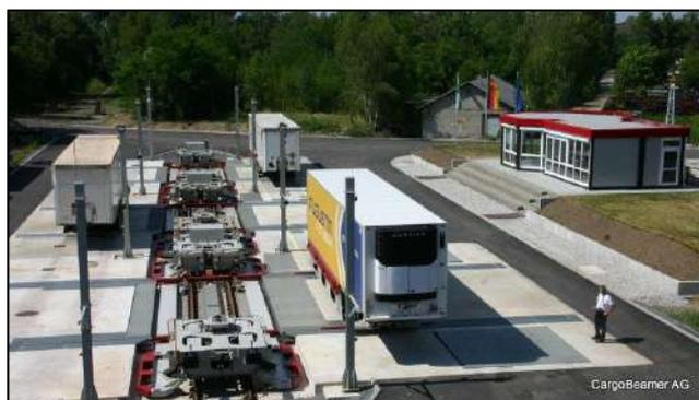
**Ilustración 55: Carga de un semirremolque con CargoBeamer (Fuente: CargoBeamer, 2020)**
