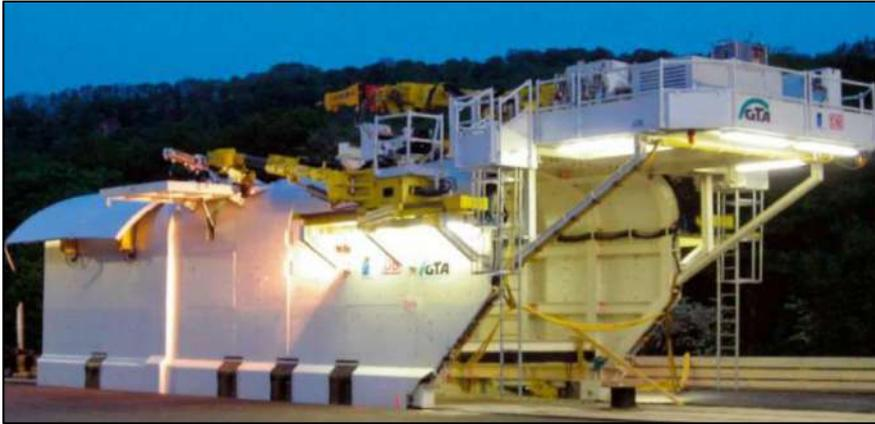
**Ilustración 246: Máquina de ampliación de gálibos (Fuente: GTA, 2017)**
