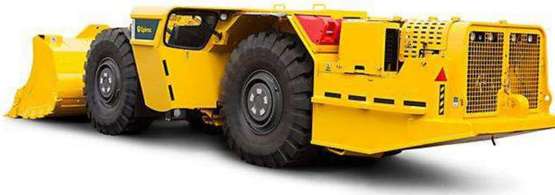
**Ilustración 262: Cargadora LHD para obras subterráneas (Fuente: Yepes, 2016)**
