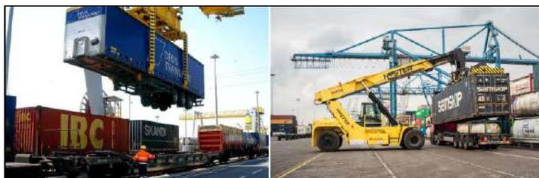
**Ilustración 49: Carga mediante grúa pórtico y reachstacker (Fuente: Hyster, 2020)**
