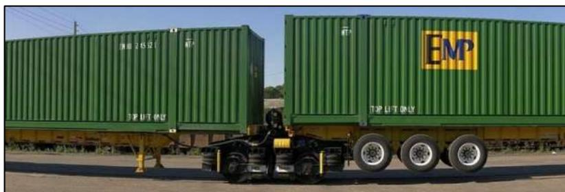
**Ilustración 57: Tren formado por una estructura bimodal (Fuente: Rail Runner, 2020)**
