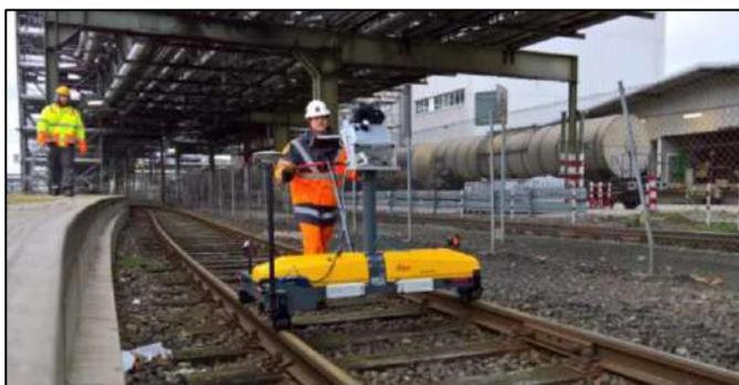
**Ilustración 78: Elemento de transporte sobre la vía (Fuente: Leica, 2020)**
