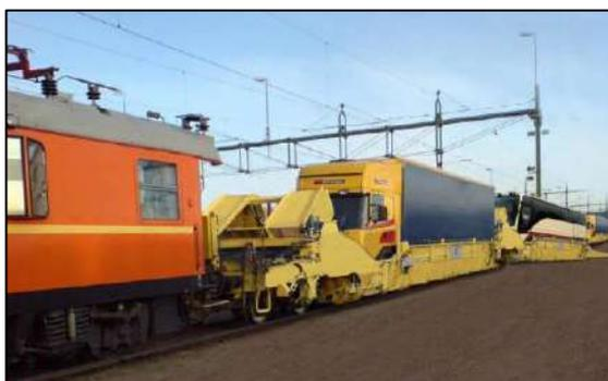
**Ilustración 54: Carga de un autobús con tecnología Flexiwaggon (Fuente: Flexiwaggon AB, 2020)**
