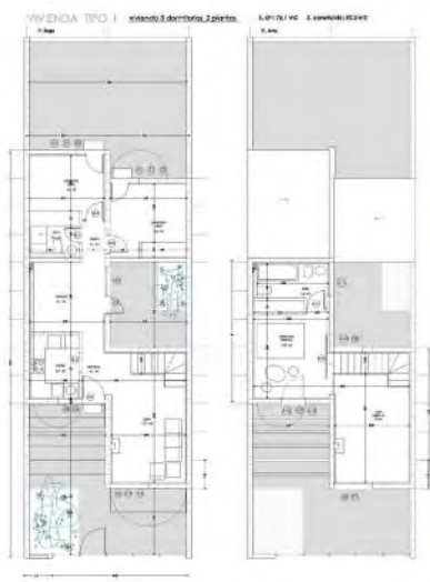
Figura 13. Ramón Araujo. Viviendas en Villarrubio. Planta y vistas de uno de los cuatro tipos de vivienda
