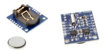
Debido a que Arduino no tiene forma de guardar la fecha y hora utilizaremos un RTC DS1307 para mantener la hora, y que pueda realizar funciones específicas en función de la hora y mostrar en pantalla los valores. Necesitan el uso de una pila CR2032 para poder almacenar la hora durante los periodos de tiempo en que no esté alimentado externamente.
