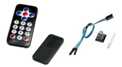
El mando a distancia emplea un LED infrarrojo para enviar una señal deseada al receptor. Al tratarse de un LED infrarrojo y no de radiofrecuencia hay que recordar que necesita línea directa entre receptor y mando para poder funcionar
