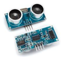
Es un dispositivo medidor de distancias. Está basado en el envío de un pulso de alta frecuencia, que rebota cuando golpea con un obstáculo y es reflejado al sensor que dispone de un micrófono adecuado para la recepción de esa frecuencia. Midiendo el tiempo transcurrido entre el envío del pulso y la recepción del mismo, y conociendo la velocidad del sonido, se puede calcular la distancia hasta el obstáculo.
