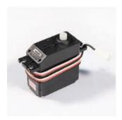
Un servo de rotación continua es una variante de los servos normales, en los que la señal que enviamos al servo controla la velocidad de giro, en lugar de la posición angular como ocurre en los servos convencionales.
