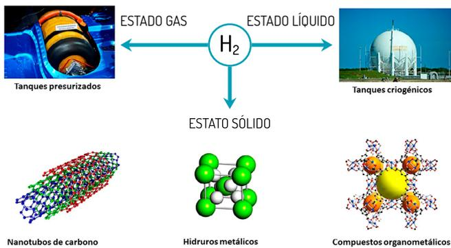
**Figura 05 » Métodos de almacenamiento de hidrógeno (Fuente: elaboración propia y Pixabay. Tanque criogénico: Heather Paul bajo CC BY-ND 2.0, tanque presurizado: agautsc on Foter.com bajo CC BY-NC 2.0., Nanotubo de carbono: Eric Wieser bajo CC BY-SA 3.0, Compuesto organometálico: Tony Boehle bajo CC BY-SA 3.0)**
