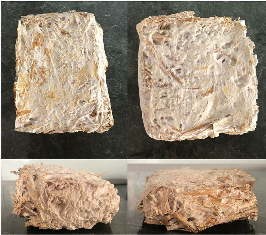
**Imagen 02** » Muestra de ladrillo de micelio después de la deshidratación al 35% y detección del crecimiento del micelio. *Imagen propia.*
