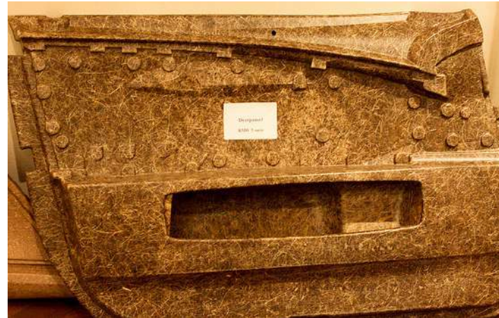
Fig. 16: Puerta delantera hecha de cáñamo del BMW i3.
