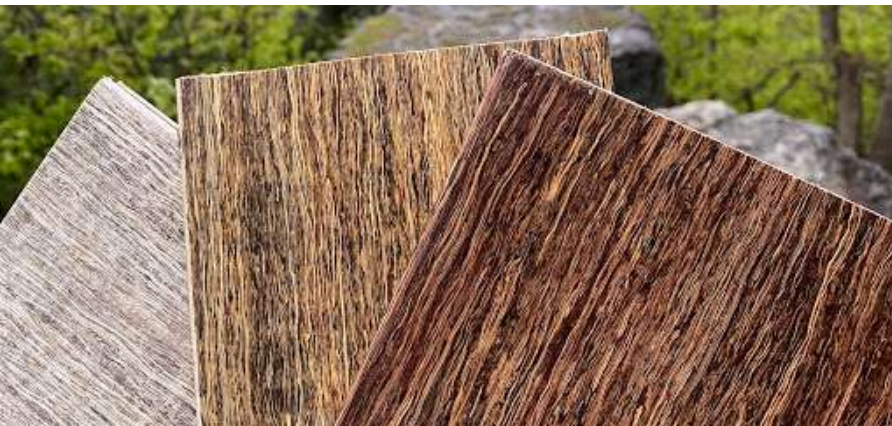
Fig. 19: Distintos acabados del contrachapado de cáñamo.
