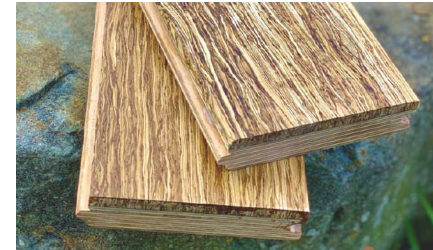
Fig. 8: Contrachapado de cáñamo. Material escogido.
