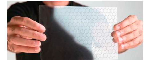
Fig. 10: Muestra de grafeno.
